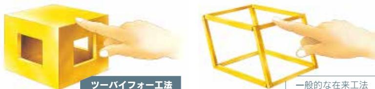
荷重を柱や筋違いだけで支える軸組み構造は、加えられた力が集中しやすく、1本の部材にかかる荷重が大きくなります。壁構造は、荷重を壁全体で負担するため、加えられた力が分散され、建物全体で外力に抵抗します。
